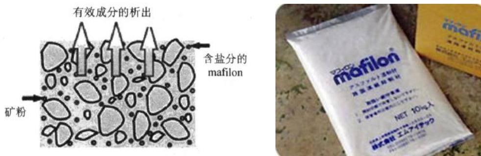
图 5-1 路面融冰雪原理示意图与抗凝冰添加剂实物图片
