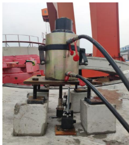
(d) 拉拔试验的位移测点位置
