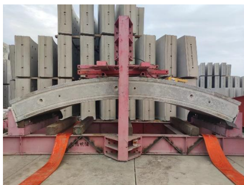
图 7.3.1-4 津兴二期预埋槽道管片抗弯试验
