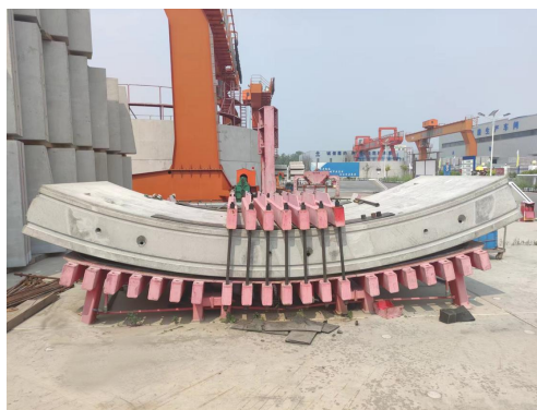
图 7.3.1-5 津兴二期预埋槽道管片抗渗试验
